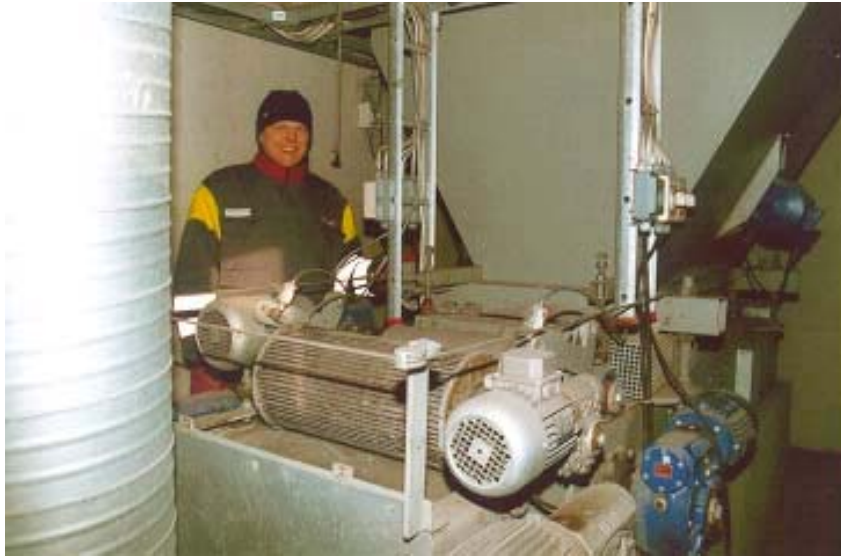
Billede 1 Anlæg til pelletering af aske. I forgrunden ses kapvalse og pressevalsen. I baggrunden ses indføringstragten. Foto: Løvgren et al. 1999.
