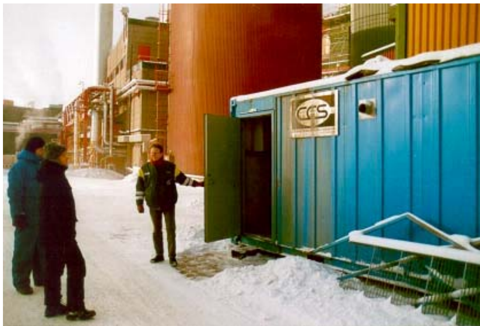
Billede 2. Anlægget til pelletering af aske kan være i en 20 fods container.
