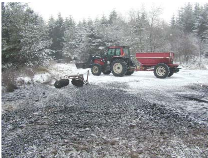
Billede 4 Lagerplads med fast bund af flis. Asken knuses med tallerkenharve og læsses på kalkspreader med traktorens frontlæsser. En valse monteret i selve spreaderen, der knuser asken, ville forbedre knusningen og lette spredningen. Foto: I. Callesen
