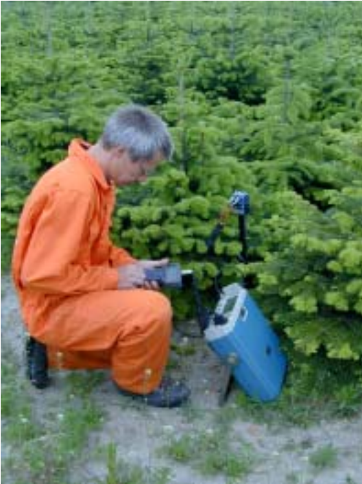
Foto: Måling af jordens vandindhold med TDR-udstyr.
