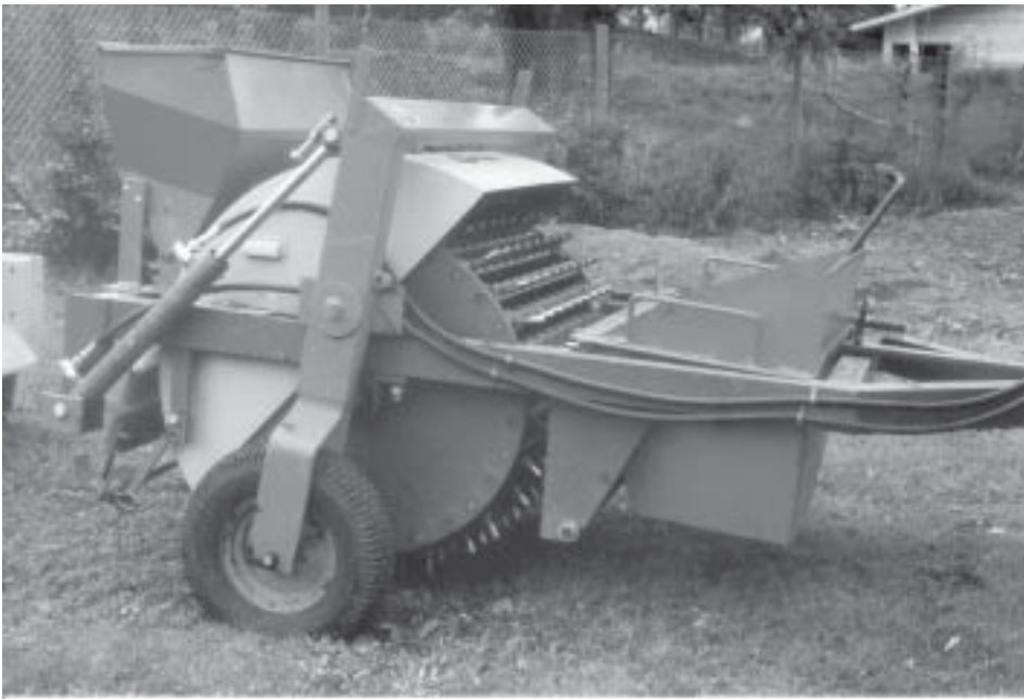
Figur 3.7. Eftersåningsmaskine til eftersåning af fodboldbaner og fairways på golfbaner. Foto: Søren Ugilt Larsen
