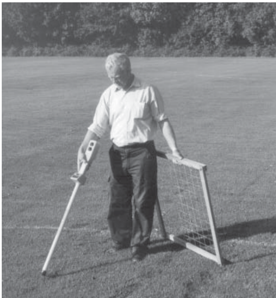
Figur 3.3. Ved måling af dækningsgrader græs, ukrudt og bar jord på fodboldbaner blev målefelternes nøjagtige placering genfundet vha. metaldetektor, der kunne lokalisere markeringssøm 15 cm under jordoverfladen. Foto: Søren Ugilt Larsen
