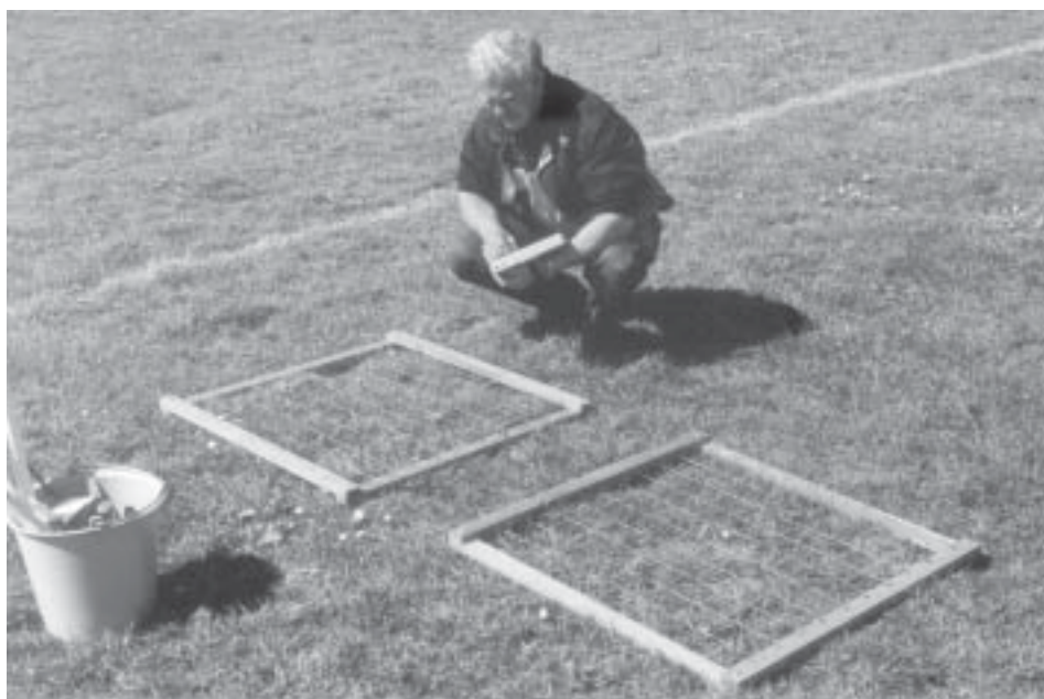
Figur 3.9. Måleramme til bestemmelse af dækningsgrader for græs, ukrudt og bar jord på fodboldbaner og golfbaner i forsøget 1999-2001. Rammen måler 75x75 cm og er inddelt i 10x10 felter. Foto: Søren Ugilt Larsen
