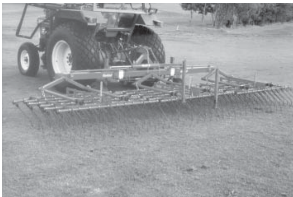
Figur 3.4. Langfingerharve til strigling af fodboldbaner og fairways på golfbaner. Foto: Søren Ugilt Larsen
