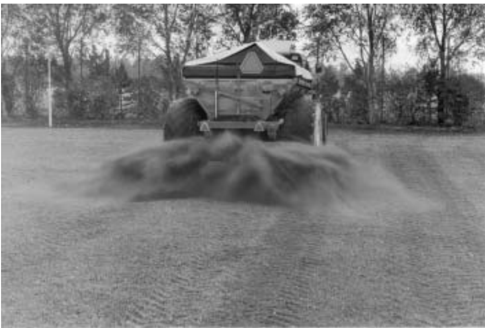
Figur 3.8. Topdresser til udbringning af topdressing på fodboldbaner. Foto: Søren Ugilt Larsen
