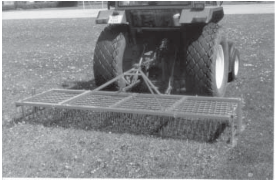
Figur 3.5. Plænestrigle til strigling af fodboldbaner og fairways på golfbaner. Foto: Søren Ugilt Larsen
