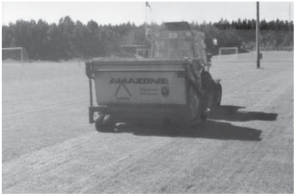
Figur 3.6. Vertikalskærer til vertikalskæring af fodboldbaner og fairways på golfbaner. Foto: Søren Ugilt Larsen
