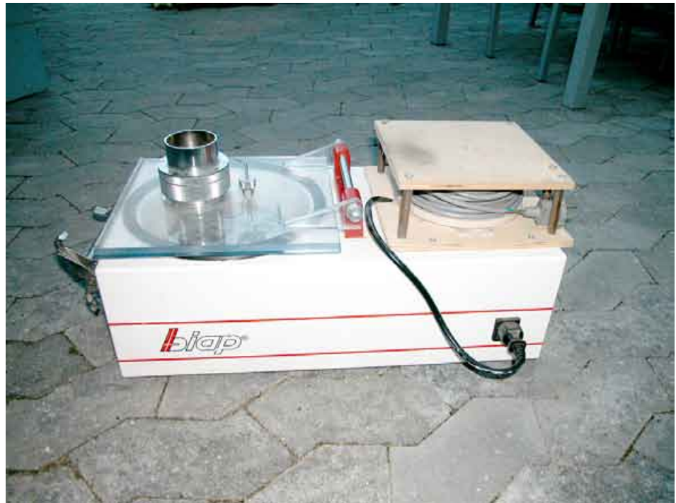
Foto 7. Biap slitsampler, som suger sporeholdig luft ned på en roterende agarplade. Når agarpladen sættes i varmeskab, spirer sporerne, og kolonierne kan derefter klassificeres og tælles.
