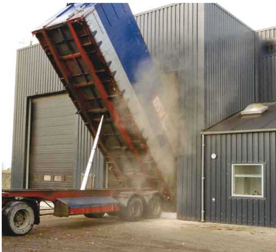
Foto 12. Her ses støv under aflæsning af flis. Hvis man opholder sig i nærheden af aflæsningsstedet, vil man blive eksponeret for træstøv. Generelt er støvniveauet lavt på flisfyrede værker, men særligt tørt eller findelt flis kan støve.
