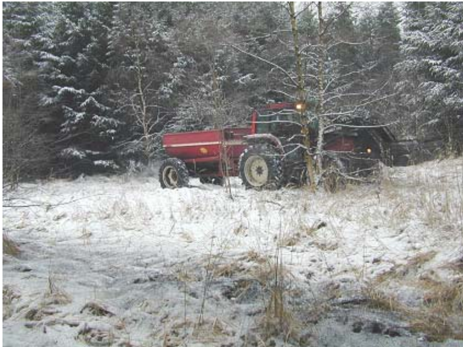
Billede 5 Asken spredes i en dosis på 1 t TS per ha med Bredahl B.40 kalkspreader og skovtraktor. Afstanden mellem sporene er 10-12 m. Aske fra kørsel i nabosporet ses i forgrunden som en sort skygge på sneen. Foto I. Callesen
