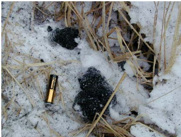
Billede 6 Den selvhærdede aske er ikke homogen. Store klumper spredes sammen med fine askepartikler. En valse, der knuser asken, ville give en mere homogen aske. Foto I. Callesen
