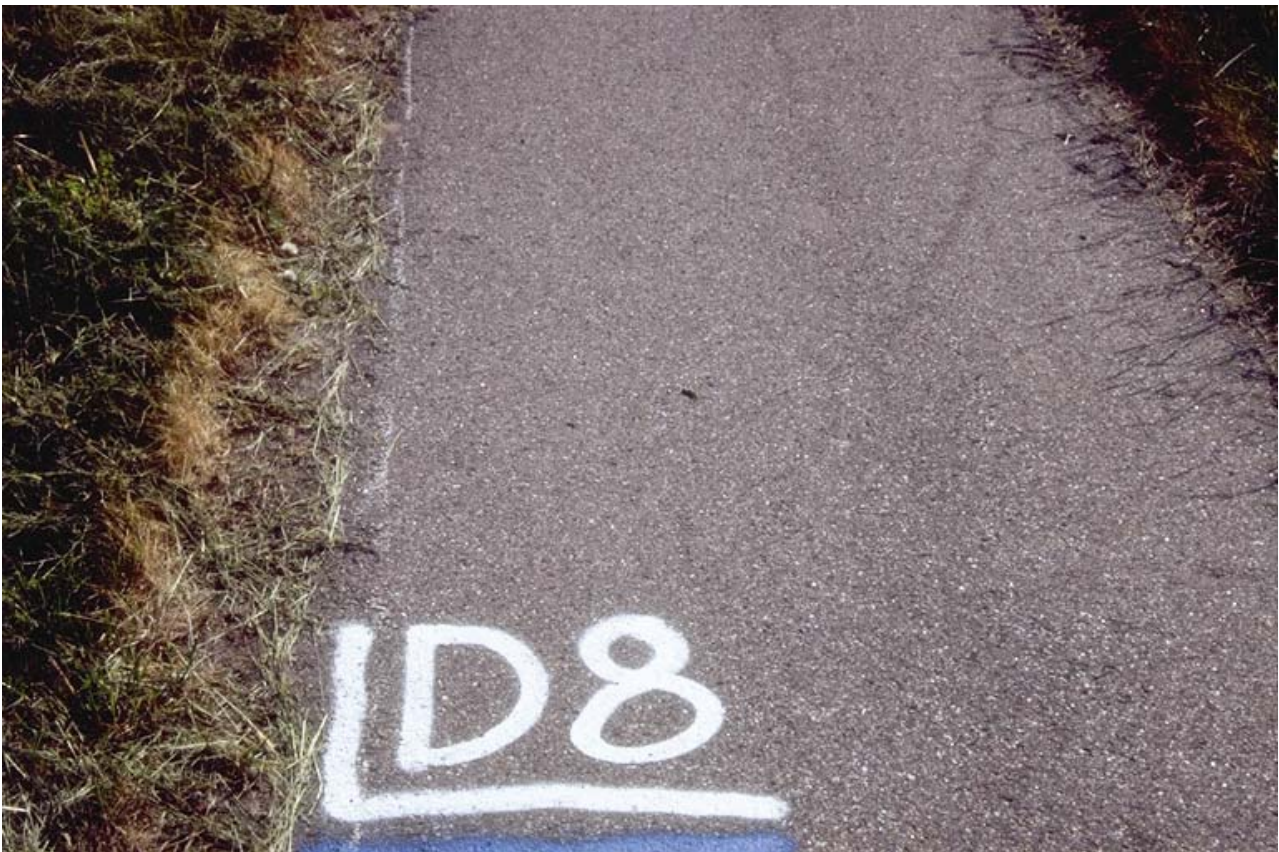
Figur 11. Billede fra 2. juni. Der har været udført tre behandlinger med damp. Den seneste 2 uger før, hvilket bevirker, at der ses vissent græs. Fejet parcel.
