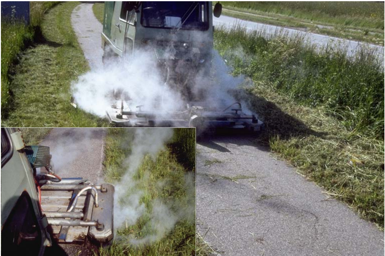
Figur 8. Billede fra 2. juni af dampbehandling af begge sider på en gang. Det afklippede græs på cykelsti-belægningen, skyldes, at der ved denne ene fejning havde været anvendt en forkert kost, der smed græsset ind over kosten. Det havde ikke betydning for renfejningen i selve rabatten.
