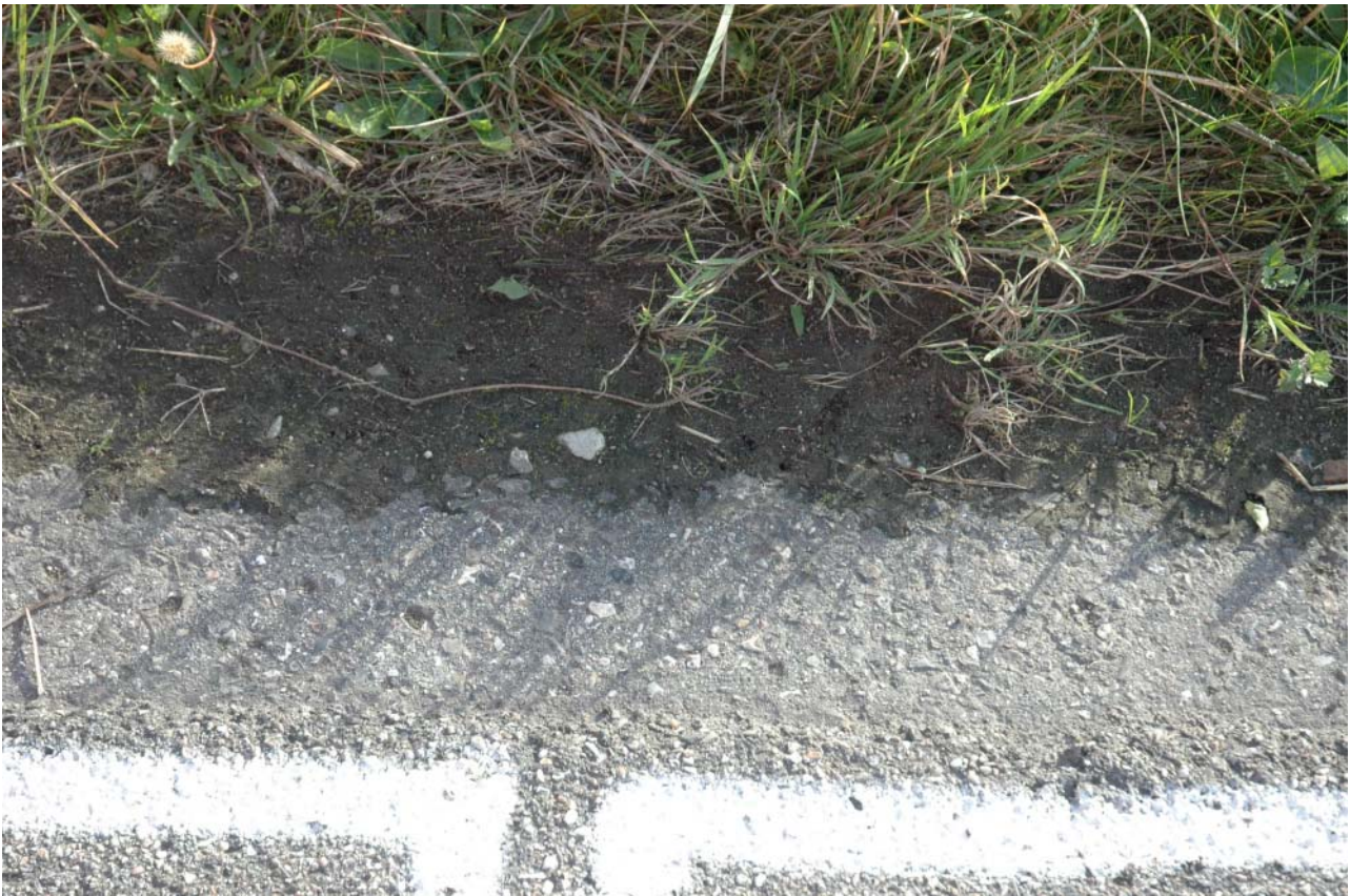
Figur 16. Billede fra 26. oktober af 8 dampbehandlinger til venstre og 6 dampbehandlinger til højre. Forskellen midt i billedet af vegetationen er et reelt billede af behandlingsforskellen. 13 dage efter behandling til venstre og 42 dage siden til højre. Fejet parcel.
