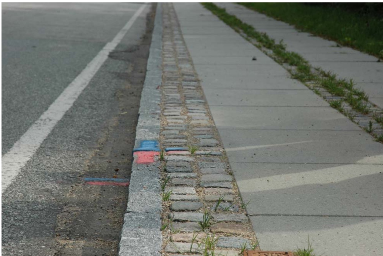
Figur 13. Billede fra Sæby den 24. august. Den røde og blå streg markerer adskillelsen mellem flammebehandling bagud og hedvandsbehandling fremad. Der ses en tydelig bekæmpelseeffekt for hedvandsbehandlingen, specielt sammenlignet med ukrudtsvæksten i chausséstensbåndet mellem fliserækkerne. Flammebehandlingen har en kraftig reducerende, men ingen dræbende effekt på ukrudtet.
