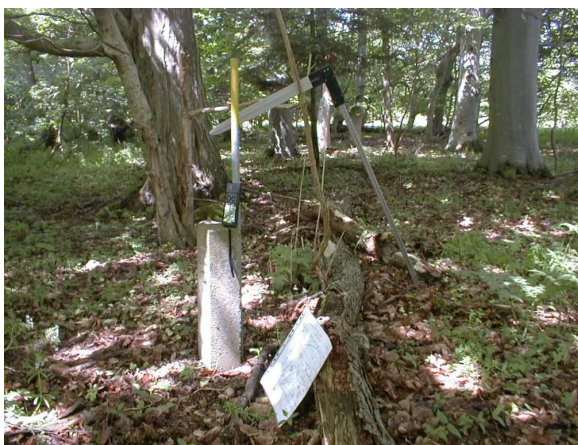
GPS, klup og feltskema ved en nummereret betonpæl
